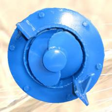
Einzugsring und Laufrad mit Schneckeneinzug sind mit WIDIA-Reißkanten aufgepanzert.
